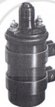
Fig. 13 - Bobina d'accensione Magneti Marelli per motocicli con motore a uno o a due cilindri.
