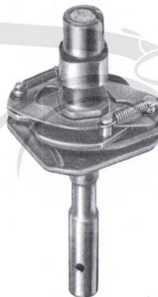
Fig. 29 - Dispositivo per l'anticipo automatico di uno spinterogeno Magneti Marelli per autovetture.
