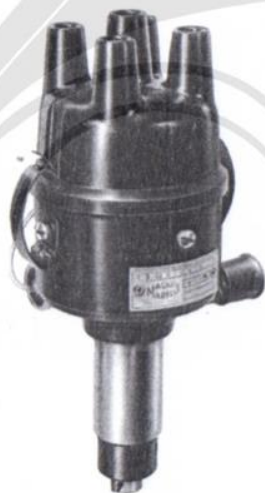
Fig. 14 - Spinterogeno Magneti Marelli (modello grande) per autoveicoli con motore a quattro cilindri.
