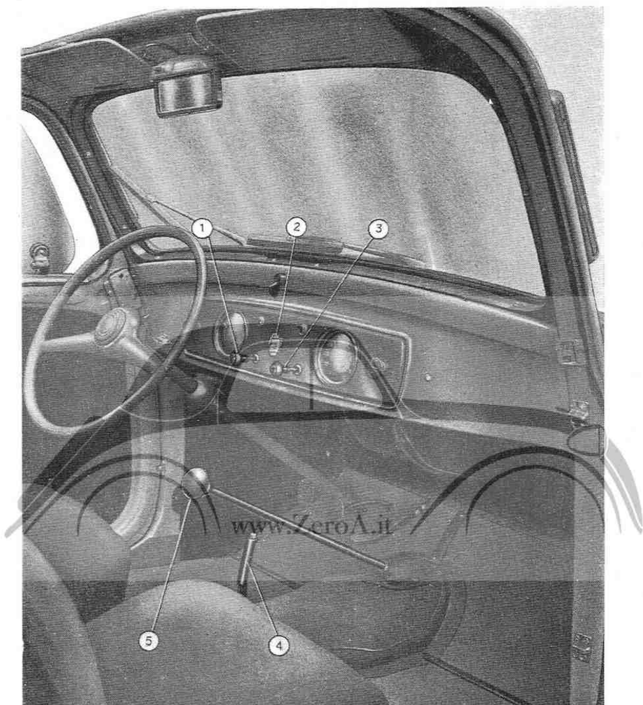
Fig. 17. - Posizione dei comandi all'avviamento a freddo del motore.
