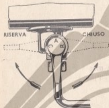
Fig. 11. — Rubinetto del serbatoio della benzina, in posizione d'apertura. A. Aperto. - R. Riserva. - C. Chiuso.
